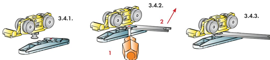
3.5. Завести в профиль: со стороны доводчика - стопор для доводчика 1674, а с другой - стопор 1627 с открытым доводом (см. рисунок в пункте 1 "Комплектация"). Выбрать места для фиксации двери в открытом и закрытом положении и закрепить стопоры, закрутив вмонтированные шурупы.
