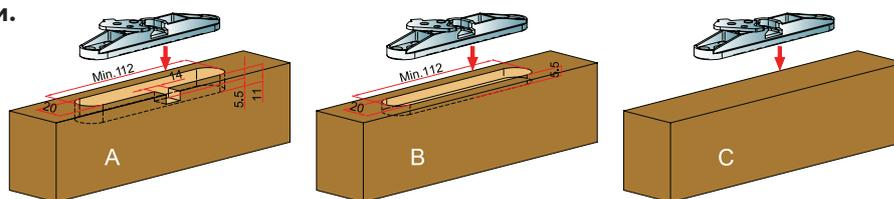
2.4. В нижней кромке дверного полотна подготовить пропил для нижнего ограничителя.
