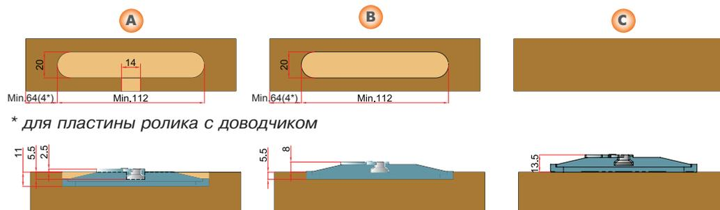
2.3. Установить монтажные пластины (без роликов) в выемке двери и закрепить саморезами.
